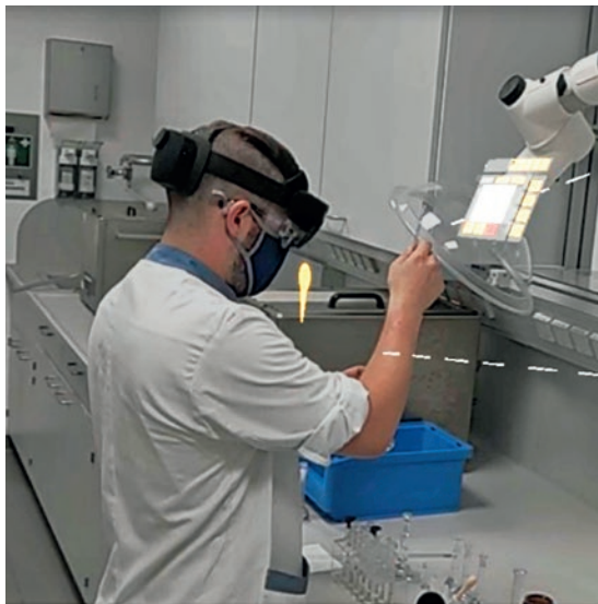
Abb. 1 Anwender bei der Durchführung einer durch das System angeleiteten Laboruntersuchung (im Hintergrund ein zur Lokalisierung genutzter 2D-Code)
